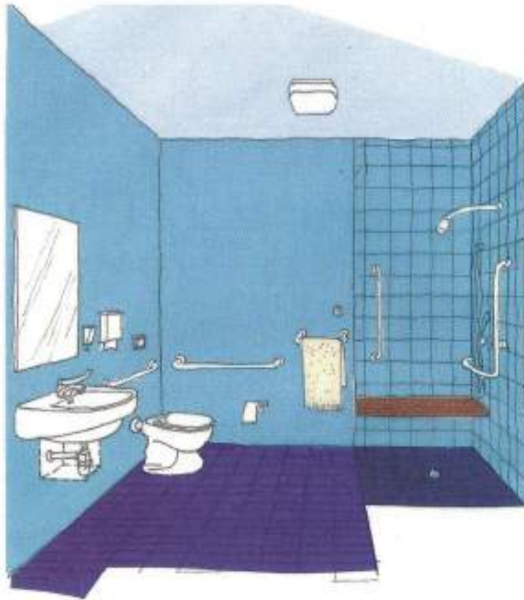
Perspectiva de um banheiro completo para deficiente
